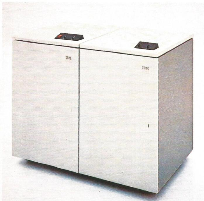
L'IBM 3310 è un'unità di memorizzazione che impiega un assieme di dischi inamovibili, sigillato e permanentemente in linea. In virtù di un nuovo design e dell'evoluzione naturale della tecnologia, essa risulta un'unità particolarmente compatta.
