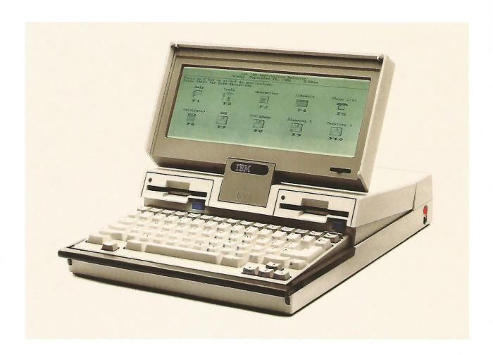
Il Personal Computer IBM Ventiquattrore è un personal computer leggero e completo che permette di lavorare in viaggio con la stessa efficienza con cui si lavora in ufficio. Il Ventiquattrore è progettato per fornire le funzioni di un elaboratore personale sia sulla scrivania (alimentato dalla rete) sia in viaggio (alimentato con batterie).
